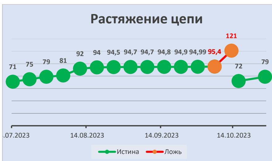
Рисунок 4. График работоспособности устройства на основе еженедельных замеров зазора между узлом верхней звёздочки и гайкой привода. Зеленым представлены значения правильной работы привода, красным натяжитель сигнализировал об ошибке, т.е. были ремонтные работы
