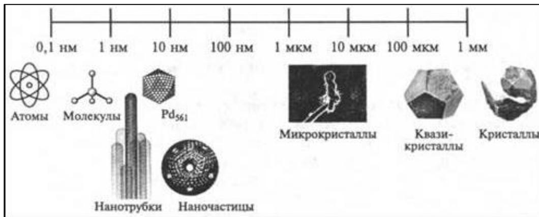
Рисунок 1. Шкала размеров частиц
