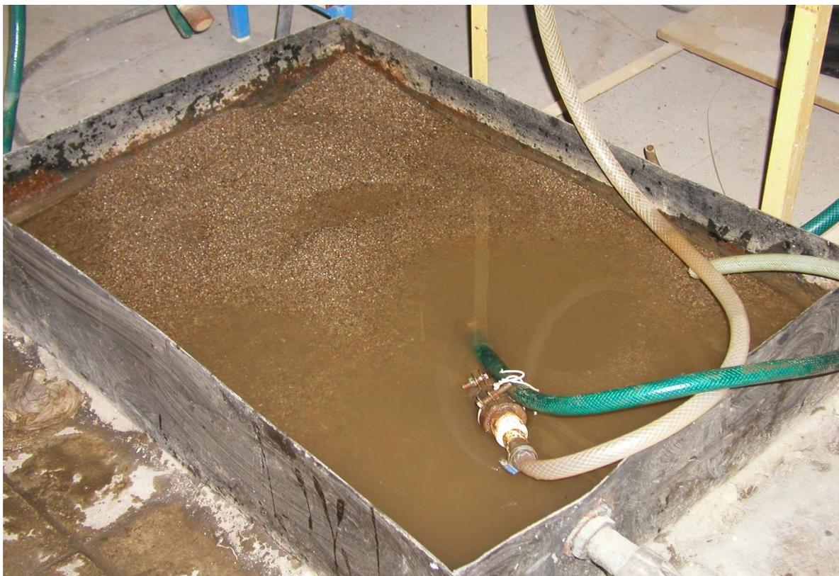
Рисунок 1. Лабораторный стенд для определения всасывающим способ гидроэлеватора при скважинной гидродобыче (СГД) песков
