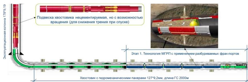
Рисунок 1. Схема 1-го этапа освоения (стимуляции пласта) компоновки заканчивания скважины
