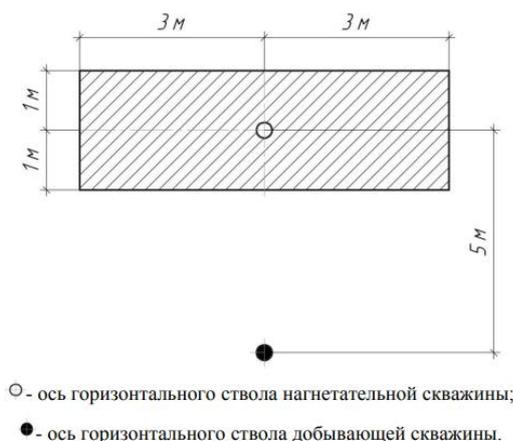
Рисунок 2. Коридор для горизонтального ствола нагнетательной скважины [4]
