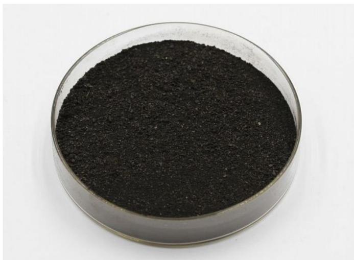
Рисунок 1. Сульфированный асфальт для буровых растворов
