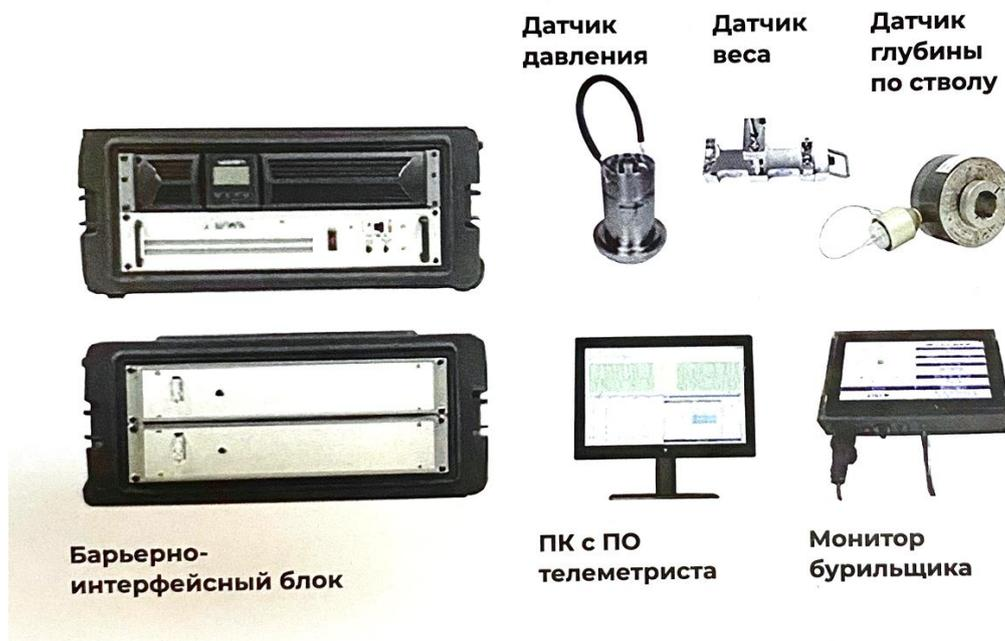
Рисунок 3. Состав надземного модуля
