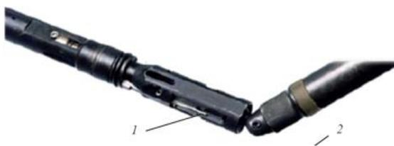
Рисунок 1. Овершот с шарниром серии CORAC компании Atlas Copco
