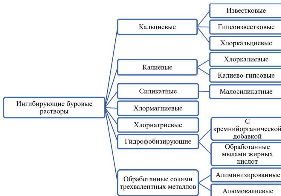
Рисунок 1. Классификация ингибирующих буровых растворов
