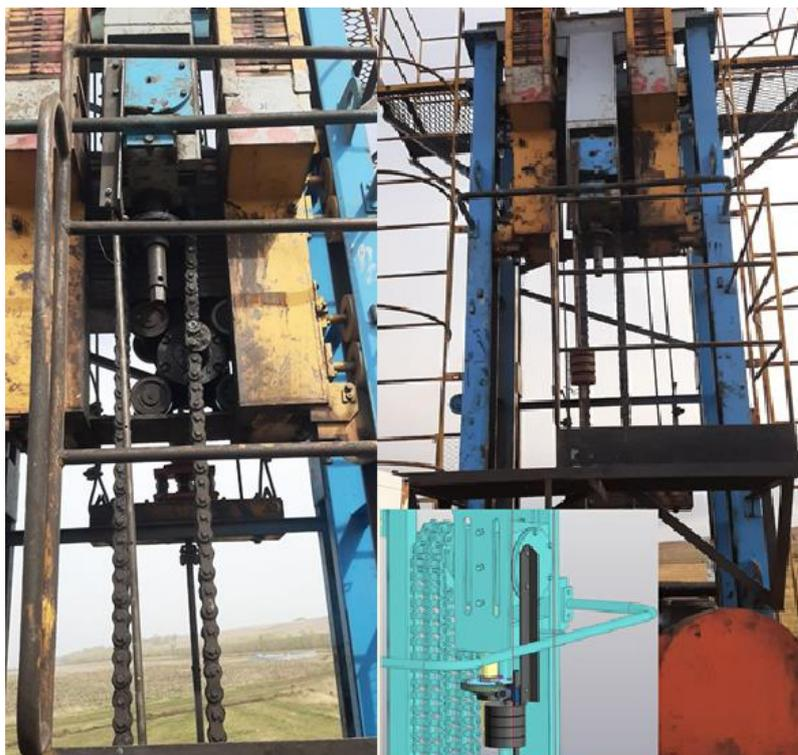
Рисунок 3. Монтаж и испытание работоспособности устройства автоматического поддержания натяжения цепи на наземный привод ПЦ 60-3-0,5/2,5
