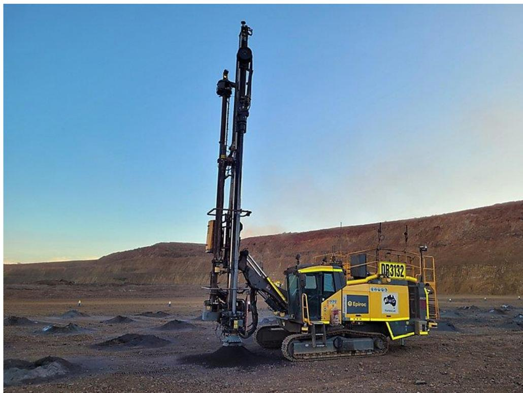
Рисунок 1. Буровой станок SmartROC D65 компании Epiroc
