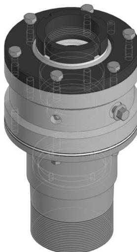
Рисунок 4. 3-х мерная модель герметизатора-превентора (общий вид)
