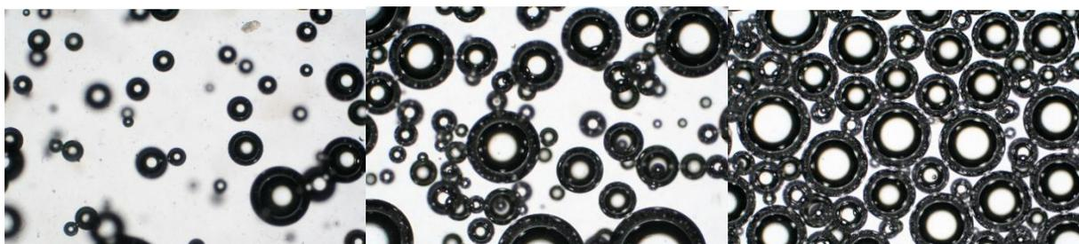
Рисунок 3. Фотография БРМП под микроскопом при различной концентрации структурообразователя
