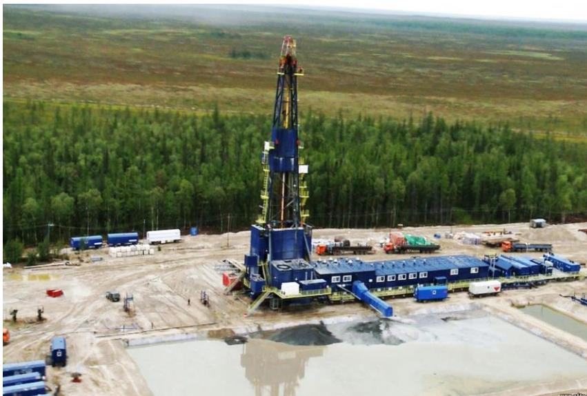
Рисунок 1. Буровая установка со шламовым амбаром
