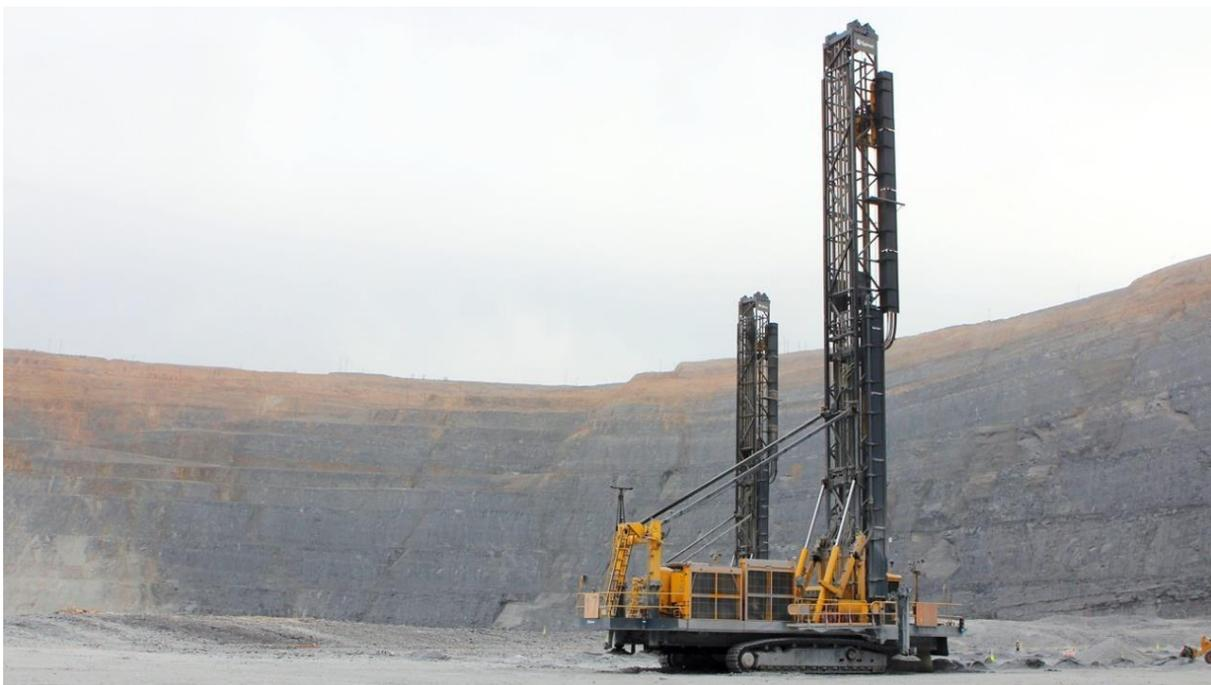
Рисунок 3. Буровой станок Pit Viper 351 компании Epiroc
