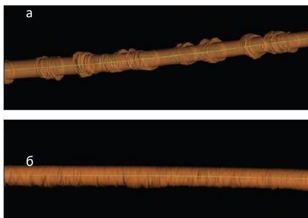
Рисунок 1. Сравнение качества ствола скважины, построенного по данным каверномера: а – забойный двигатель с кривым переводником; б – РУС
