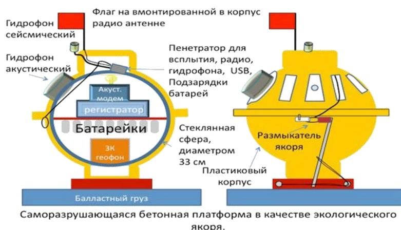
Рисунок 1. Конструкция самовсплывающей ДСС
