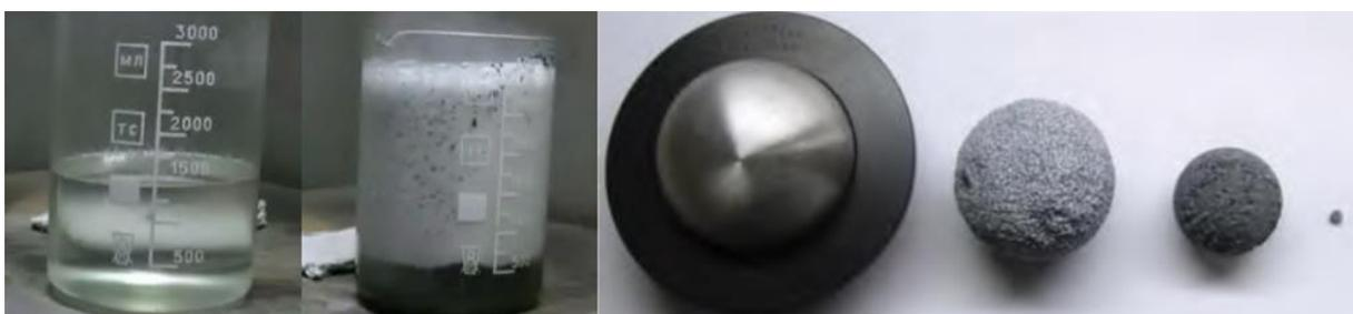
Рисунок 2. Процесс растворения шара в 20% растворе лимонной кислоты
