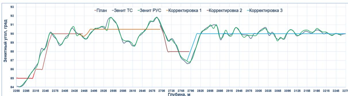
Рисунок 2. Сравнительный анализ зависимости зенитных углов при изменении команд РУС
