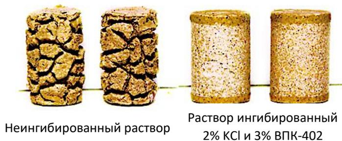
Рисунок 2. Результат ингибирования глин
