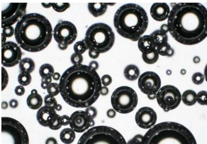
Рисунок 1. Фотография БРМП под микроскопом
