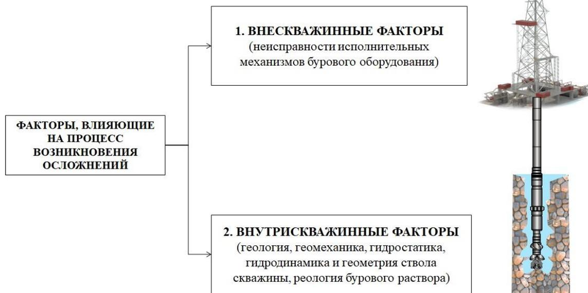
Рисунок 2. Блок-схема группы факторов влияющих на процесс возникновения осложнений
